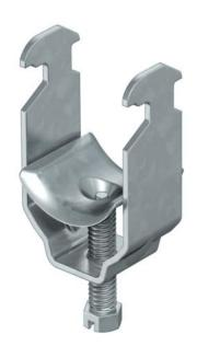
Passend zu allen C-Profilschienen mit 16 - 17 mm Schlitzweite. Schelle, Schraube und Druckwanne aus tauchfeuerverzinktem Stahl.
