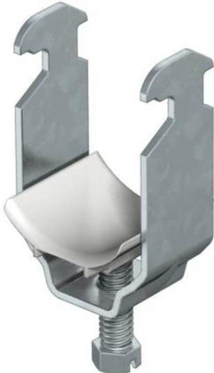
Passend zu allen C-Profilshienen mit 16 - 17 mm Schlitzweite. Shelle und Schraube aus tauchfeuerverzinktem Stahl, Druckwanne aus Polypropylen, halogenfrei, Farbe Lichtgrau RAL 7035. Ausführung mit Anschweiß- und/oder Kontermutter für Einsatz unter erschwerten Bedingungen sowie für Rüttelsicherheit auf Anfrage!
