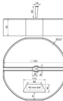
Betonsockel für Fangstangen, zum Schutz von kleineren Dachaufbauten auf Flachdächern und für das Errichten von Distanzhaltern z. B. für getrennte Ringleitungen oder freistehende Fangstangen im Dreibeinstatus.
