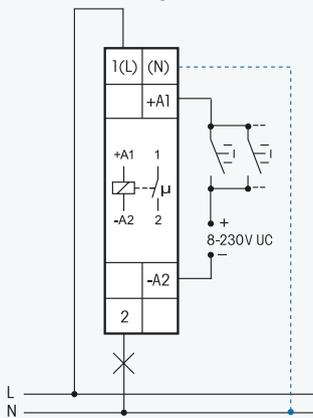
Bei angeschlossenem N ist die Kontaktschaltung im Nulldurchgang aktiv.
