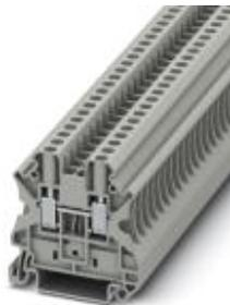
Durchgangsklemme, Nennspannung: 1000 V, Nennstrom: 32 A, Anschlussart: Schraubanschluss, Anzahl der Anschlüsse: 2, Querschnitt: 0,14 mm<sup>2</sup> - 6 mm<sup>2</sup>, AWG: 26 - 10, Breite: 6,2 mm, Höhe: 46,9 mm, Farbe: grau, Montageart: NS 35/7,5, NS 35/15
