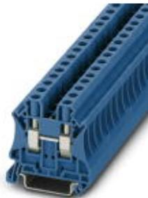
Durchgangsklemme, Nennspannung: 1000 V, Nennstrom: 41 A, Anschlussart: Schraubanschluss, Anzahl der Anschlüsse: 2, Querschnitt: 0,2 mm<sup>2</sup> - 10 mm<sup>2</sup>, AWG: 24 - 8, Breite: 8,2 mm, Höhe: 46,9 mm, Farbe: blau, Montageart: NS 35/7,5, NS 35/15
