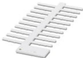
Einsteckschild, Streifen, weiß, unbeschriftet, beschriftbar mit: CMS-P1-PLOTTER, Montageart: auffädeln, Kabeldurchmesserbereich: 1,5-35 mm, Schriftfeldgröße: 23 x 4 mm
