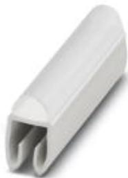
Ader-Bezeichnungsträger, transparent, unbeschriftet, Montageart: aufclipsen, Kabeldurchmesserbereich: 2,8-4,4 mm, Schriftfeldgröße: 4 x 23 mm
