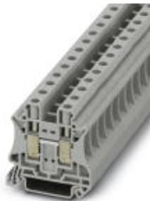
Durchgangsklemme, Nennspannung: 1000 V, Nennstrom: 57 A, Anschlussart: Schraubanschluss, Anzahl der Anschlüsse: 2, Querschnitt: 0,5 mm<sup>2</sup> - 16 mm<sup>2</sup>, AWG: 20 - 6, Breite: 10,2 mm, Höhe: 46,9 mm, Farbe: grau, Montageart: NS 35/7,5, NS 35/15
