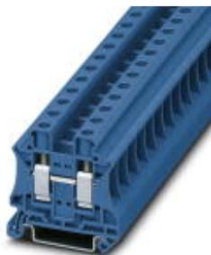
Durchgangsklemme, Nennspannung: 1000 V, Nennstrom: 57 A, Anschlussart: Schraubanschluss, Anzahl der Anschlüsse: 2, Querschnitt: 0,5 mm<sup>2</sup> - 16 mm<sup>2</sup>, AWG: 20 - 6, Breite: 10,2 mm, Höhe: 46,9 mm, Farbe: blau, Montageart: NS 35/7,5, NS 35/15
