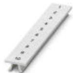
Zackband, Streifen, weiß, beschriftet, beschriftbar mit: CMS-P1-PLOTTER, quer bedruckt: fortlaufende Zahlen 1-10, 11-20 usw. bis 491-500, Montageart: verrasten in hoher Schildchennut, für Klemmenbreite: 6,2 mm, Schriftfeldgröße: 6,15 x 10,5 mm
