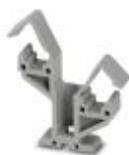
Doppel-Auflagebock, aus Isolierstoff, wahlweise verwendbar für Sammelschiene 3 x 10 mm oder 6 x 6 mm, Höhe in geschlossenem Zustand: 39 mm
