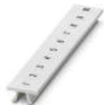
Zackband, Streifen, weiß, beschriftet, beschriftbar mit: CMS-P1-PLOTTER, längs bedruckt: fortlaufende Zahlen 1-10, 11-20 usw. bis 491-500, Montageart: verrasten in hoher Schildchennut, für Klemmenbreite: 6,2 mm, Schriftfeldgröße: 6,15 x 10,5 mm
