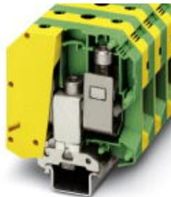
Schutzleiter-Reihenklemme, Anschlussart: Schraubanschluss, Anzahl der Anschlüsse: 2, Polzahl: 1, Querschnitt: 25 mm<sup>2</sup> - 95 mm<sup>2</sup>, AWG: 4 - 3/0, Breite: 25 mm, Farbe: grün-gelb, Montageart: NS 35/7,5, NS 35/15, NS 32
