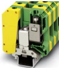
Schutzleiter-Reihenklemme, Anschlussart: Schraubanschluss, Anzahl der Anschlüsse: 2, Polzahl: 1, Querschnitt: 16 mm<sup>2</sup> - 50 mm<sup>2</sup>, AWG: 6 - 1/0, Breite: 20 mm, Farbe: grün-gelb, Montageart: NS 35/7,5, NS 35/15, NS 32
