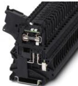
Sicherungsreihenklemme, Art der Sicherung: Glas / Keramik / ..., Anschlussart: Schraubanschluss, Querschnitt: 0,14 mm<sup>2</sup>- 6 mm<sup>2</sup>, AWG: 26 - 10, Nennstrom: 6,3 A, Nennspannung: 500 V, Breite: 6,2 mm, Sicherungstyp: G / 5 x 20, Montageart: NS 35/7,5, NS 35/15, Farbe: schwarz
