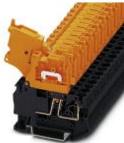
Hebeltrennklemme, Nennspannung: 500 V, Nennstrom: 20 A, Anschlussart: Zugfederanschluss, Anzahl der Anschlüsse: 2, Querschnitt: 0,08 mm<sup>2</sup> - 6 mm<sup>2</sup>, AWG: 28 - 10, Breite: 6,2 mm, Farbe: schwarz/orange, Montageart: NS 35/7,5, NS 35/15
