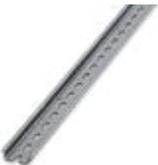
Tragschiene gelocht, Standardprofil, Breite: 35 mm, Höhe: 7,5 mm, nach EN 60715: 2001, Material: Stahl, verzinkt, weiß-passiviert, Länge: 2000 mm, Farbe: weiß
