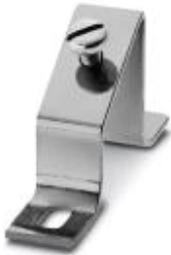
Schrägbügel mit Schraube M6, zur Befestigung der Tragschienen in einem Neigungswinkel von 30°, Höhe: 46 mm
