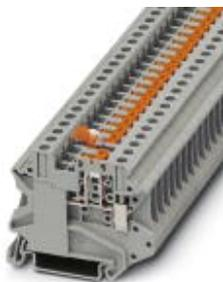
Messertrennklemme, mit Prüfbuchschrauben zur Aufnahme von Prüfsteckern, Nennspannung: 500 V, Nennstrom: 20 A, Anschlussart: Schraubanschluss, Querschnitt: 0,14 mm<sup>2</sup> - 6 mm<sup>2</sup>, AWG: 26 - 10, Länge: 57,8 mm, Breite: 6,2 mm, Farbe: grau, Montage: NS 35/7,5, NS 35/15, Nennspannung: 500 V
