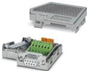
D-SUB Stecker, 9-polige Buchse, zwei Kabelzuführungen unter 35° auf eine Klemmreihe, Bussystem: CAN, CANopen®, SafetyBus-P bis 1 MBit/s, Abschlusswiderstand über Schiebeschalter zuschaltbar, Pinbelegung: 2,3,7; Schraubanschlussklemmen
