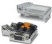
D-SUB-Stecker, 9-polige Buchse, Kabelzuführung unter 35°, Bussystem: CAN, CANopen<sup>®</sup>, SafetyBus-P bis 1 MBit/s, mit PG D-SUB-Buchse zum Anschluss eines Programmiergeräts, Abschlusswiderstand ü. Schiebeschalter zuschaltbar, Pinbelegung: 2, 3, 7, 9; Schraubklemmen
