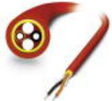
Polymerfaserkabel, duplex 980 µm / 1000 µm, schwere Ausführung für die Verlegung in stationären Anlagen und Maschinen, Meterware ohne Stecker
