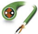
Konfektionierbare, hochflexible POF-PROFINETleitung (nur IP20-Köpfe), für den Einsatz in Schleppketten. Einzelemente aus hochstrapazierfähigem Polyamid (PE). Die Leitung ist halogenfrei, Ozon- und UV-beständig, mit robustem Polyurethan (PUR) Außenmantel.
