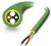
Konfektionierbare POF-PROFINET-Installationsleitung (nur IP20-Köpfe), für Verlegung in stationären Anlagen und Maschinen, Einzelemente aus Polyamid (PE), halogenfrei, Ozon- und UV-beständig, mit verstärktem Polyurethan-(PUR)-Außenmantel
