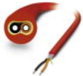
Konfektionierbare POF-Installationsleitung (nur IP20-Köpfe) für Verlegung in stationären Anlagen und Maschinen, Einzelemente aus Polyamid (PE), halogenfrei, Ozon- und UV-beständig, mit Polyurethan-(PUR)-Außenmantel
