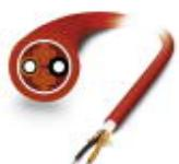
Konfektionierbare, hochflexible POF-Rundleitung (nur IP20-Köpfe) für den Einsatz in Schleppketten. Einzelementen aus hochstrapazierfähigem Polyamid (PE). Die Leitung ist halogenfrei, Ozon- und UV-beständig mit robustem Polyurethan (PUR) Außenmantel.
