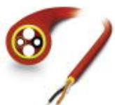
Konfektionierbare, robuste POF-Installationsleitung (nur IP20-Köpfe) für Verlegung in stationären Anlagen und Maschinen, Einzelemente aus Polyamid (PE), halogenfrei, Ozon- und UV-beständig, mit verstärktem Polyurethan-(PUR)-Außenmantel
