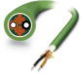
PROFINET-Polymerfaserkabel, duplex 980/1000 µm, schwere hochflexible Ausführung für Schleppkettenanwendungen, Meterware ohne Stecker
