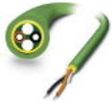
PROFINET-Polymerfaserkabel, duplex 980 µm / 1000 µm, schwere Ausführung für die Verlegung in stationären Anlagen und Maschinen, Meterware ohne Stecker
