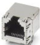
RJ45-Buchseneinsatz, für Leiterplattenmontage, CAT6, 8-polig, geschirmt, mit gewinkelten Lötstiften, 1-fach
