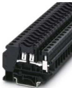
Flachsicherungsklemme, Querschnitt: 0,2-6 mm 2 , AWG: 26-8, Breite: 8,2 mm, Farbe: schwarz
