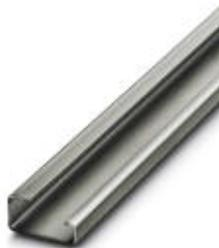
Tragschiene ungelocht, G-Profil, Breite: 32 mm, Höhe: 15 mm, nach EN 60715: 2001, Material: Stahl, verzinkt, dickschichtpassiviert, Länge: 2000 mm, Farbe: silberfarben
