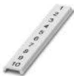
Zackband flach, Streifen, weiß, beschriftet, quer bedruckt: fortlaufende Zahlen 1-10, 11-20 usw. bis 91-100, Montageart: verrasten in flacher Schildchennut, für Klemmenbreite: 4 mm, Schriftfeldgröße: 4,2 x 5,2 mm
