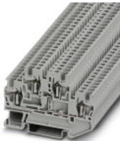
Doppelstock-Zugfederklemme, Anschlussart: Zugfederanschluss, Querschnitt: 0,08 mm<sup>2</sup> - 1,5 mm<sup>2</sup>, AWG: 28 - 16, Breite: 4,2 mm, Farbe: grau, Montageart: NS 35/7,5, NS 35/15
