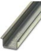
Tragschiene ungelocht, Standardprofil, Breite: 35 mm, Höhe: 15 mm, ähnlich EN 60715: 2001, Material: Stahl, verzinkt, dickschichtpassiviert, Länge: 2000 mm, Farbe: silberfarben
