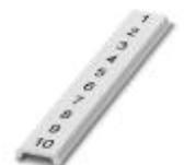
Zackband flach, Streifen, weiß, beschriftet, quer bedruckt: fortlaufende Zahlen 1-10, 11-20 usw. bis 91-100, Montageart: verrasten in flacher Schildchennut, für Klemmenbreite: 4 mm, Schriftfeldgröße: 4,2 x 5,2 mm
