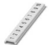
Zackband flach, Streifen, weiß, beschriftet, längs bedruckt: fortlaufende Zahlen 1-10, 11-20 usw. bis 91-100, Montageart: verrasten in flacher Schildchennut, für Klemmenbreite: 4 mm, Schriftfeldgröße: 4,2 x 5,2 mm
