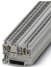
Durchgangsklemme, Nennspannung: 500 V, Nennstrom: 17,5 A, Anschlussart: Zugfederanschluss, Anzahl der Anschlüsse: 2, Querschnitt: 0,08 mm<sup>2</sup> - 1,5 mm<sup>2</sup>, AWG: 28 - 16, Breite: 4,2 mm, Farbe: grau, Montageart: NS 35/7,5, NS 35/15
