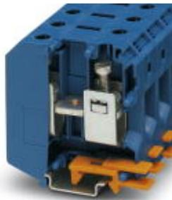
Hochstromklemme, Nennspannung: 1000 V, Nennstrom: 150 A, Anschlussart: Schraubanschluss, Anzahl der Anschlüsse: 2, Polzahl: 1, Querschnitt: 16 mm<sup>2</sup> - 70 mm<sup>2</sup>, AWG: 6 - 2/0, Breite: 20 mm, Höhe: 75,8 mm, Farbe: blau, Montageart: NS 35/7,5, NS 35/15, NS 32, NS 35/15-2,3
