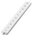
Marker für Klemmen, Streifen, weiß, beschriftet, beschriftbar mit: CMS-P1-PLOTTER, längs: U, V, W, N, GND, U, V, W, N, GND, Montageart: verrasten in hoher Schildchennut, für Klemmenbreite: 10,2 mm, Schriftfeldgröße: 10,15 x 10,5 mm
