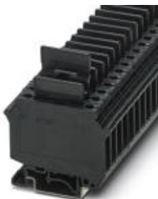
Sicherungsklemme für G-Sicherungseinsatz 5 x 20 und 5 x 25, Querschnitt: 0,2 - 4 mm 2 , Breite: 8,2 mm, Farbe: schwarz
