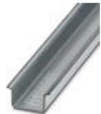
Tragschiene ungelocht, Standardprofil, Breite: 35 mm, Höhe: 15 mm, ähnlich EN 60715: 2001, Material: Stahl, verzinkt, Länge: 2000 mm, Farbe: silberfarben
