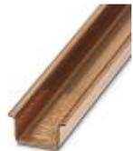
Tragschiene ungelocht, Standardprofil, Breite: 35 mm, Höhe: 15 mm, ähnlich EN 60715: 2001, Material: Kupfer, unbeschichtet, Länge: 2000 mm, Farbe: kupferfarben
