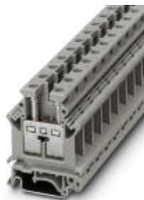
Durchgangsklemme, Nennspannung: 800 V, Nennstrom: 76 A, Anschlussart: Schraubanschluss, Anzahl der Anschlüsse: 2, Querschnitt: 2,5 mm<sup>2</sup> - 25 mm<sup>2</sup>, AWG: 14 - 4, Breite: 12,2 mm, Farbe: grau, Montageart: NS 35/7,5, NS 35/15, NS 32
