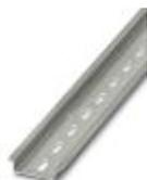
Tragschiene gelocht, Standardprofil, Breite: 35 mm, Höhe: 7,5 mm, nach EN 60715: 2001, Material: Stahl, verzinkt, dickschichtpassiviert, Länge: 2000 mm, Farbe: silber
