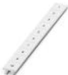
Zackband, Streifen, weiß, beschriftet, beschriftbar mit: CMS-P1-PLOTTER, quer bedruckt: fortlaufende Zahlen 1-10, 11-20 usw. bis 991-1000, Montageart: verrasten in hoher Schildchennut, für Klemmenbreite: 10,2 mm, Schriftfeldgröße: 10,15 x 10,5 mm
