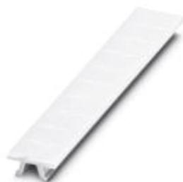
Marker für Klemmen, Streifen, weiß, beschriftet, beschriftbar mit: CMS-P1-PLOTTER, längs bedruckt: U, V, W, N, GND, U, V, W, N, GND, Montageart: verrasten in hoher Schildchennut, für Klemmenbreite: 6,2 mm, Schriftfeldgröße: 6,15 x 10,5 mm
