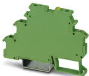
Eingabe-Solid-State-Relaisklemme, Eingang: 5 V DC, Ausgang: 3 - 48 V DC/ 100 mA, Klemmenbreite 6,2 mm
