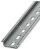
Tragschiene gelocht, Standardprofil, Breite: 35 mm, Höhe: 7,5 mm, nach EN 60715: 2001, Material: Stahl, verzinkt, Länge: 2000 mm, Farbe: silberfarben
