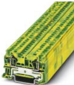
Zugfeder-Schutzleiterklemme, Anschlussart: Zugfederanschluss, Anzahl der Anschlüsse: 2, Querschnitt: 0,08 mm<sup>2</sup> - 6 mm<sup>2</sup>, AWG: 28 - 10, Breite: 6,2 mm, Farbe: grün-gelb, Montageart: NS 35/7,5, NS 35/15
