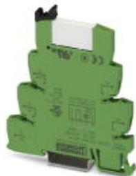
PLC-INTERFACE, bestehend aus Grundklemme PLC-BSC.../21 mit Schraubanschluss und steckbarem Miniaturrelais mit Leistungskontakt, zur Montage auf Tragschiene NS 35/7,5, 1 Wechsler, Eingangsspannung 12 V DC
