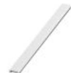
Zackband flach, Streifen, weiß, unbeschriftet, beschriftbar mit: CMS-P1-PLOTTER, PLOTMARK, Montageart: verrasten in flacher Schildchennut, für Klemmenbreite: 8 mm, Schriftfeldgröße: 5,15 x 8,15 mm
