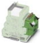
V8-Adapter für 8 x PLC-INTERFACE (6,2 mm); Steuerung: SPS-Systemverkabelung von Ausgangskarten; Anschluss 1: Steckanschluss; Anschluss 2: 1x D-SUB-Stiftleiste (15-polig); Anzahl der Kanäle: 8; Ansteuerlogik: plusschaltend
