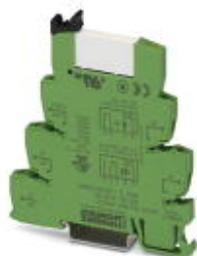
PLC-INTERFACE, bestehend aus Grundklemme PLC-BSC.../21 mit Schraubanschluss und steckbarem Miniaturrelais mit Leistungskontakt, zur Montage auf Tragschiene NS 35/7,5, 1 Wechsler, Eingangsspannung 230 V AC/220 V DC
