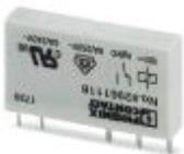
Steckbares Miniatur-Leistungsrelais, mit Leistungskontakt, 1 Wechsler, Eingangsspannung 60 V DC
