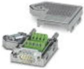
D-SUB-Stecker, 9-polig, Stift, eine Kabelzuführung unter 35°, Universaltyp für alle Systeme, Pinbelegung: 1, 2, 3, 4, 5, 6, 7, 8, 9 auf Schraubanschlussklemme
