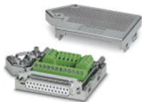
D-SUB-Stecker, 25-polige Buchse, eine Kabelzuführung unter 35°, Universaltyp für alle Systeme, Pinbelegung: 1,2,3,...,24,25 auf Schraubanschlussklemme
