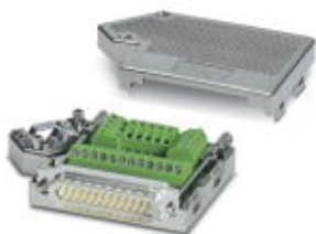
D-SUB-Stecker, 25-polig, Stift, eine Kabelzuführung unter 35°, Universaltyp für alle Systeme, Pinbelegung: 1,2,3,...,24,25 auf Schraubanschlussklemme
