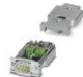
D-SUB-Stecker, 9-polig, Stift, axiale Ausführung mit zwei Kabelzuführungen, Bussystem: PROFIBUS DP bis 12 MBit/s, Abschlusswiderstand über Schiebeschalter zuschaltbar, Pinbelegung: 3, 5, 6, 8; Federkraftanschlussklemmen
