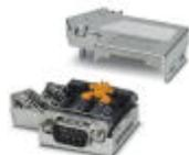
D-SUB-Stecker, 9-polig, Stift, Kabelzuführung unter 35°, Bussystem: PROFIBUS DP bis 12 MBit/s mit PG-D-SUB-Buchse zum Anschluss eines Programmiergeräts, Abschlusswiderstand ü. Schiebeschalter zuschaltbar, Pinbelegung: 3, 5, 6, 8; Schraubanschlussklemmen
