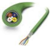
Netzwerkkabel, PROFINET CAT5 (100 MBit/s), 4-polig, PVC, grün RAL 6018, geschirmt, freies Leitungsende, auf freies Leitungsende, Kabellänge: Freie Eingabe (0,5 ... 400 m)
