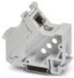
Tragschienenadapter, Bauform: RJ45, Schutzart: IP20, Polzahl: 8, 10 GBit/s, CAT6<sub>A</sub>, Material: PC-GF, Anschlussart: IDC-Anschluss, Anschlussquerschnitt: AWG 26-22, Farbe: grau
