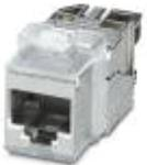
RJ45-Buchseneinsatz, Bauform: RJ45, Schutzart: IP20, Polzahl: 8, 10 GBit/s, CAT6<sub>A</sub>, Material: Zink-Druckguss, Anschlussart: IDC-Anschluss, Anschlussquerschnitt: AWG 26-22, Verwendung nur mit IP20-Anbaurahmen oder direkte Integration in die Gehäusewand
