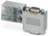
D-SUB-Stecker, 9-polig, Stift, Kabelzuführung unter 90°, Bussystem: PROFIBUS DP bis 12 MBit/s mit PG-D-SUB-Buchse zum Anschluss eines Programmiergeräts, Abschlusswiderstand über Schiebeschalter zuschaltbar, Pinbelegung: 3, 5, 6, 8; IDC-Klemmenanschluss
