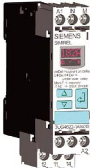
Digitales Überwachungsrelais Stromüberwachung, 22.5 mm von 0,05-10 A AC/DC Über- und Unterschreitung AC/DC 24 bis 240 V DC und AC 50 bis 60 Hz Anlauf- und Störspitzenverzög. 0,1 bis 20 s Hysterese 0,01 bis 5 A 1 Wechsler mit oder ohne Fehlerspeicher Schraubanschluss Nachfolgeprodukt für 3UG3522-1AL20, 3UG3522-1AG20 und 3UG3522-1AC48-0AA1
