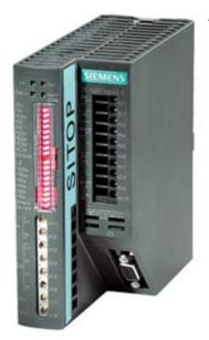
SITOP DC-USV-MODUL 6A OHNE SCHNITTSTELLE SITOP DC-USV-Modul 24 V/6 A Unterbrechungsfreie Stromversorgung ohne Schnittstelle Eingang: DC 24 V/6,85 A Ausgang: DC 24 V/6 A
