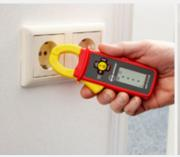
Mit der Funktion zur berührungslosen Spannungserkennung kann geprüft werden, ob eine Spannung anliegt.
