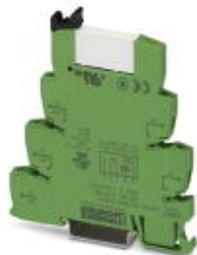
PLC-INTERFACE, bestehend aus Grundklemme PLC-BSC.../21 mit Schraubanschluss und steckbarem Miniaturrelais mit Mehrlagen-Goldkontakt, zur Montage auf Tragschiene NS 35/7,5, 1 Wechsler, Eingangsspannung 24 V AC/DC
