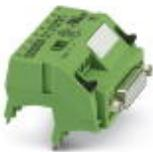
V8-Adapter für 8 x PLC-INTERFACE (6,2 mm); Steuerung: SPS-Systemverkabelung von Eingangskarten; Anschluss 1: Steckanschluss; Anschluss 2: 1x D-SUB-Buchsenleiste (15-polig); Anzahl der Kanäle: 8; Ansteuerlogik: plusschaltend
