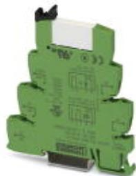
PLC-INTERFACE, bestehend aus Grundklemme PLC-BSC.../21 mit Schraubanschluss und steckbarem Miniaturrelais mit Mehrlagen-Goldkontakt, zur Montage auf Tragschiene NS 35/7,5, 1 Wechsler, Eingangsspannung 230 V AC/220 V DC
