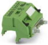
V8-Adapter für 8 x PLC-INTERFACE (6,2 mm); Steuerung: SPS-Systemverkabelung von Eingangskarten; Anschluss 1: Steckanschluss; Anschluss 2: 1x IDC/FLK-Stiftleiste (14-polig); Anzahl der Kanäle: 8; Ansteuerlogik: minusschaltend
