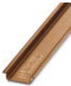
Tragschiene ungelocht, Standardprofil, Breite: 35 mm, Höhe: 7,5 mm, nach EN 60715: 2001, Material: Kupfer, unbeschichtet, Länge: 2000 mm, Farbe: kupferfarben
