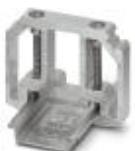
Endhalter, zur Endabstützung der UKH 50 bis UKH 240, wird auf die Tragschiene NS 35 geschoben und mit 2 Schrauben festgeklemmt, Breite: 10 mm, Farbe: aluminium
