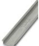
Tragschiene ungelocht, Standardprofil, Breite: 35 mm, Höhe: 7,5 mm, nach EN 60715: 2001, Material: Stahl, verzinkt, dickschichtpassiviert, Länge: 2000 mm, Farbe: silberfarben
